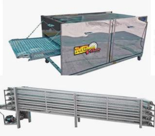
Chasis cocedor automático doble, dos niveles de cocimiento especial para totilla de trigo, malla de salida recibe automáticamente la tortilla que arroja el cabezal
